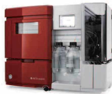
图 1. ÄKTA avant 是一种设计用于方法探索、纯化优化和制备放大的层析系统。
